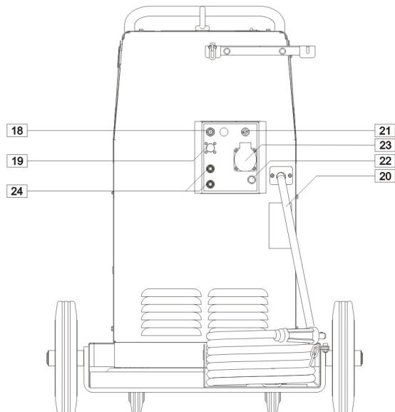
18. **Connecteur gaz:** Pour le raccordement du tuyau souple d'alimentation gaz.
