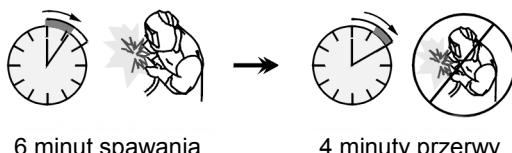
Nadmiernie wydłużenie cyklu pracy urządzenia może spowodować uaktywnienie się układu zabezpieczenia termicznego.
