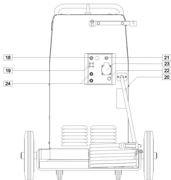
18. **Encaixe:** Para conexão da mangueira de alimentação de gás.
