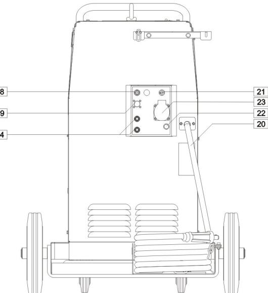
18. **Газовый разъем:** для подключения газового шланга.
