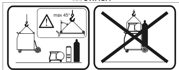
W celu zapewnienia bezpiecznego transportu urządzenia należy:
