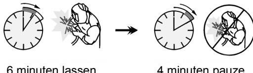
Excessieve verlenging van de inschakelduur activeert het thermisch beveiligingscircuit.
