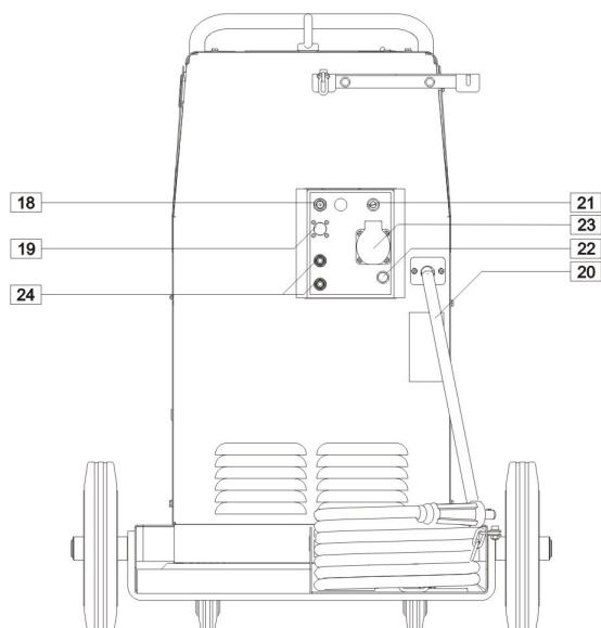
18. Gassventil: For tilkobling av gasslangen fra regulatoren.
