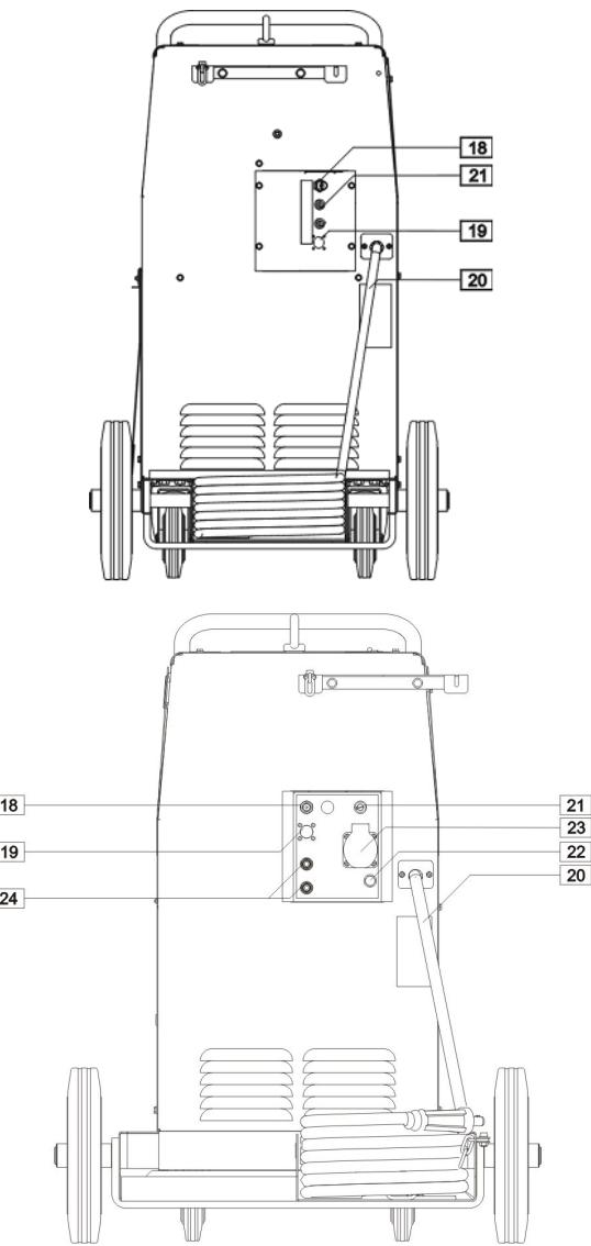
18. **Presa:** Per collegamento del tubo del gas in arrivo.
