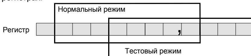
Рис. 11.1 Изменение отображения дисплея в нормальном и тестовом режимах
