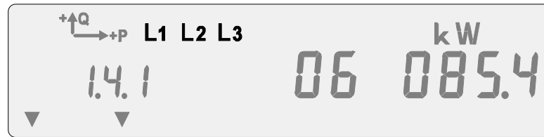
Рис. 9.12 Отображение чередования фаз
