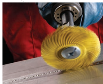
Осветление сварного шва
