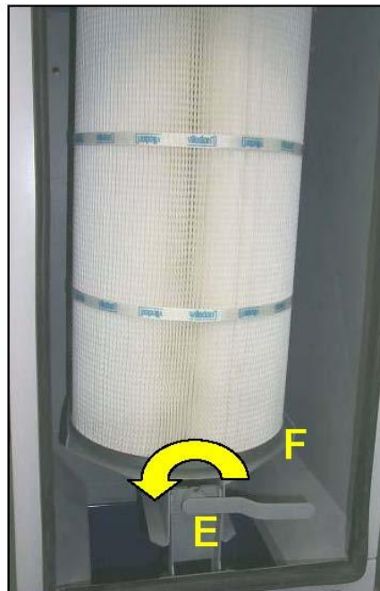
Рисунок 15: Удаление патрона фильтра (С400 МК4)
