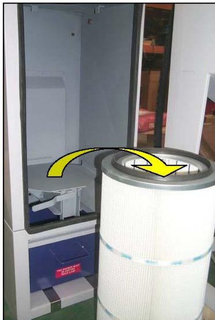
Рисунок 15: Удаление патрона фильтра (С400 МК4)
