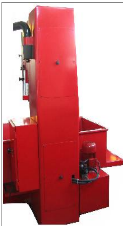
Рис. 3.6. Защитная пластина, закрывающая заднюю часть.
