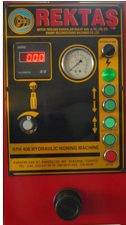
Рис. 3.2. Кнопка аварийного останова.
