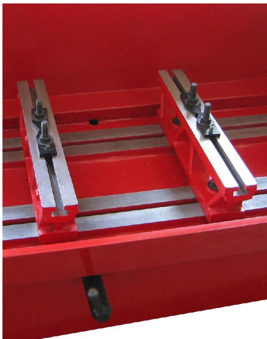
Рис. 6.3. Регулировка расстояния между параллелями.
