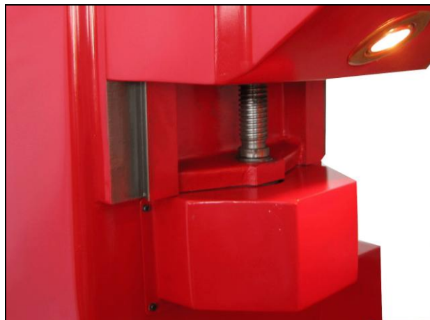
Рис. 3.3. Направляющие коробки подач.
