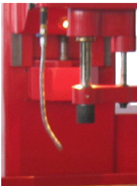
Рис. 6.7. Шланг и форсунка охлаждающей жидкости.
