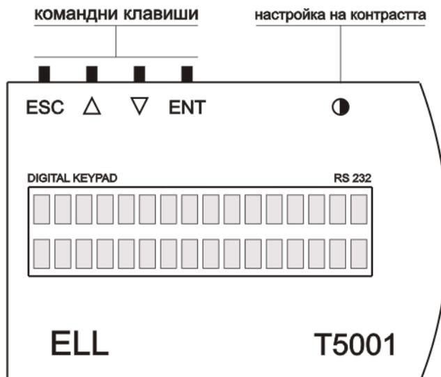
Рисунок 6-1 Терминал для настройки T5001
