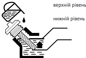
**Не нахиляйте генератор при додаванні масла, це може привести до переливу масла вище максимального рівня і поломки двигуна.**
