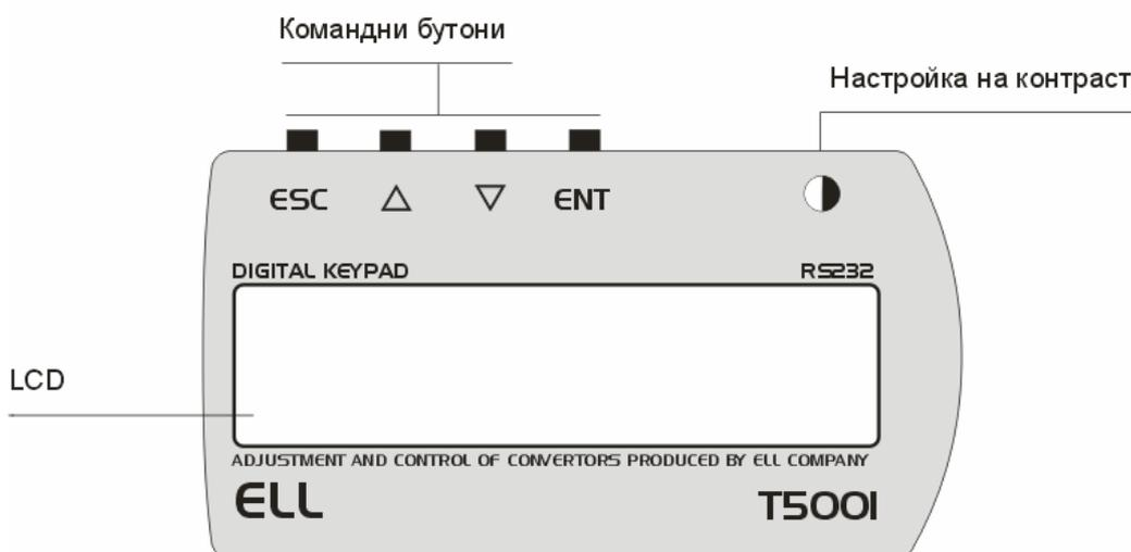
Фиг. 1 Лицевая панел терминала T5001
