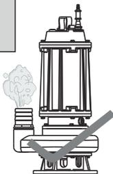
Після ввімкнення потужність повітря на виході дуже мала, і навіть відсутня: електричний насос працює у зворотному напрямку
