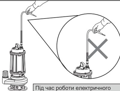
Під час роботи електричного насоса кабель не можна тягнути або використовувати як підйомний канат
