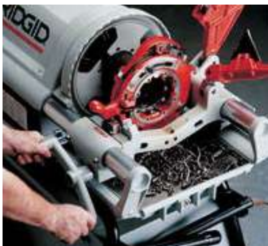
Резьбонарезная голова со ступенчатой регулировкой модели 714 (914).
