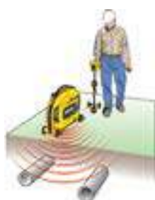
Подача сигнала для определения местоположения инженерных сетей.
