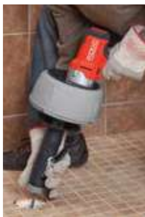
Спираль \frac{3}{8} " (10 мм) в модели K-45AF-5 расширяет возможности машины, позволяя прочищать сточные трубопроводы диаметром до 2\frac{1}{2} " (75 мм).
