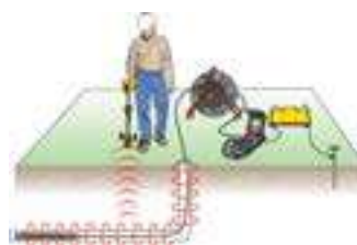
Поиск пластмассовых труб при помощи встроенного передатчика.
