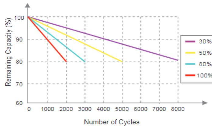
Зависимость количества рабочих циклов от глубины разряда аккумулятора
