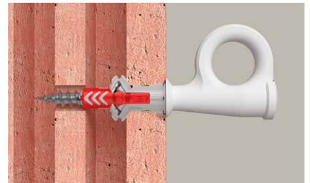
В комбинации с дюбелем DuoPower EasyHook также подходит для пустотелого кирпича.
