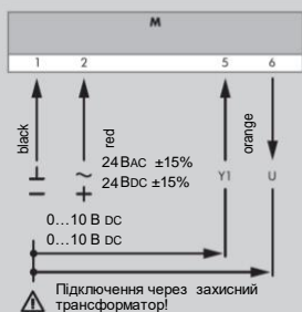
Схема підключення додаткових контактів NAFM...20S
