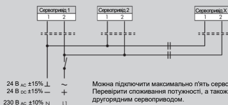
Схема підключень NAFA...03(S) Паралельне підключення
