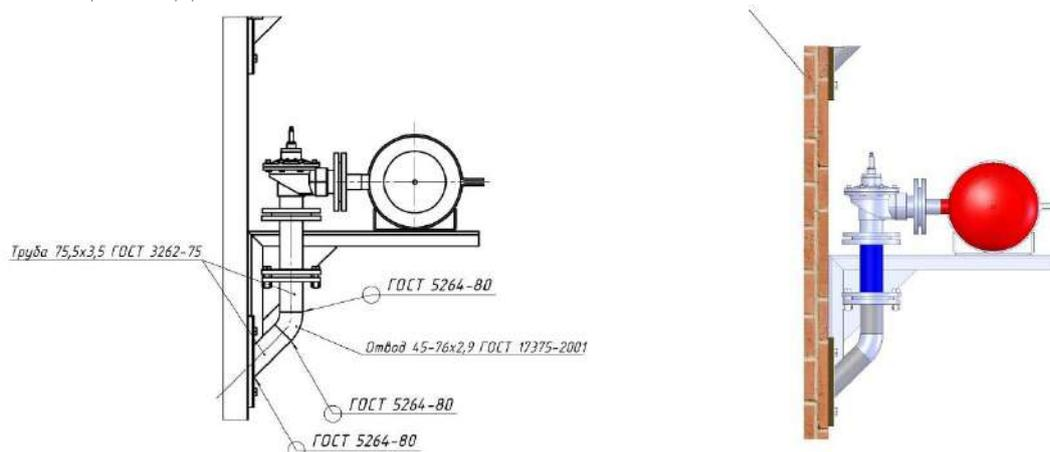
Устройство ПИУ ЭКСЕН™: крепится к ресиверу с помощью фланцев или с помощью резьбы. Для отключения данного устройства из системы без удаления воздуха из ресивера предусмотрен запорный шаровой вентиль.
