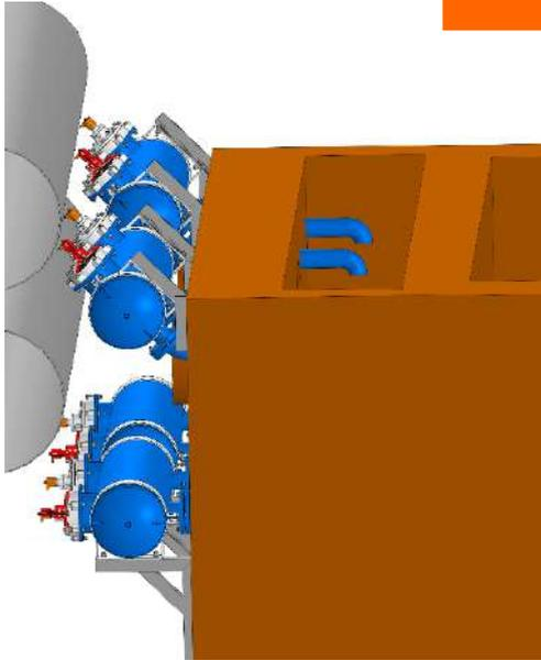
Установка Системы обдувки поверхности нагрева котла позволяет экономить до 15% топлива.
