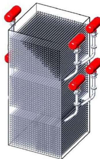
**Внимание!!!** Количество пневмоимпульсных устройств ЭКСЕН™ и интервал между импульсами подачи воздуха зависят от размера и конструкции котла, а также от вида топлива.
