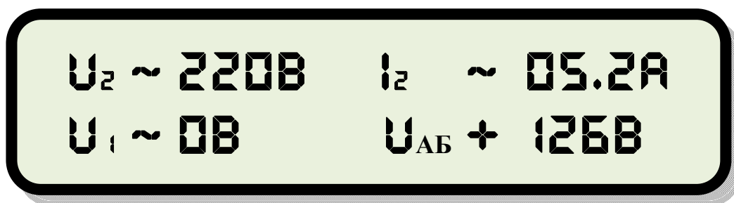
Рис.8. Индикатор на передней панели ИБП, где: U_1 – 0В (нет входящей сети 220В); U_2 – 220В (напряжение на выходе ИБП); U_{AB} – 126В (напряжение на АКБ); I_2 – 05.2А (ток потребляемый проверочной нагрузкой);
