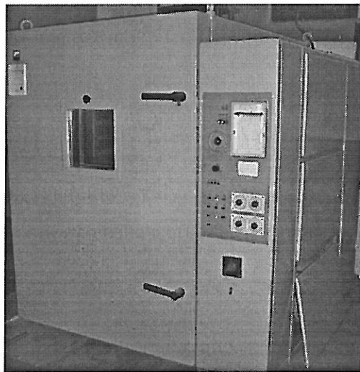
Рисунок 1 – Кліматична камера для проведення циклічних кліматичних випробувань
