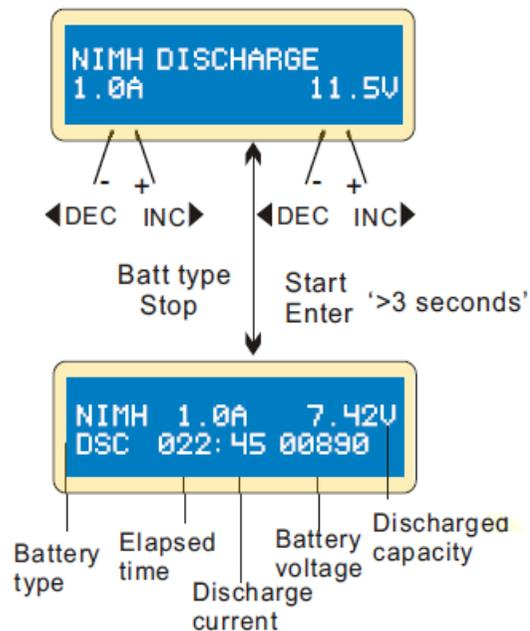
Установите разрядный ток в левой части дисплея и конечное напряжение в правой части. Диапазон тока устанавливается в пределах 0.1-1.0A; напряжения в пределах 0.1-25.0V. Нажмите и удерживайте более 3-х секунд кнопку **START/ENTER** для запуска программы.
