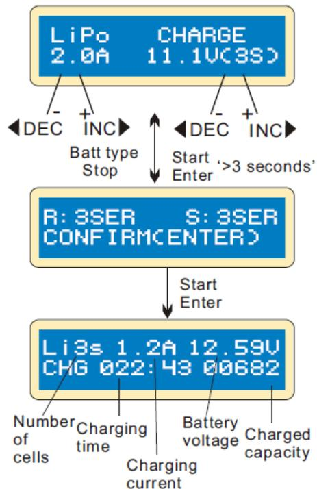
Левая сторона первой линии показывает выбранный тип батареи. Значение во второй линии дисплея показывает установленный ток. После выбора тока и напряжения нажмите и удерживайте более 3-х секунд кнопку **START/ENTER** для запуска процесса заряда. (Зарядный ток: 0.1-5.0A, напряжение: 3.7-22.2V).
