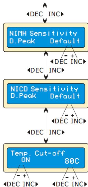
Здесь показано пороговое напряжение для автоматического останова зарядки NiMH и NiCd батарей. Эффективное значение варьируется от 5 до 20mV на ячейку. Если установить значение порогового напряжения выше, существует опасность перезаряда батарей; если значение установить ниже – будет существовать возможность преждевременного отключения. Данные значения необходимо уточнить по техническим характеристикам батарей. (NiCd по умолчанию: 12mV, NiMH по умолчанию: 7mV)
