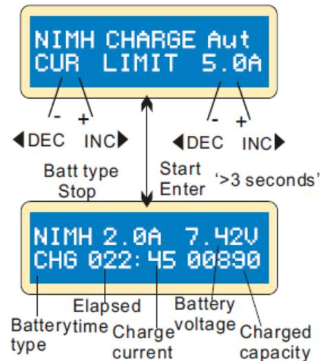
Эта программа используется для зарядки NiCd/NiMH батарей, применяемых в радиоуправляемых моделях. Пользователь может нажать кнопку **START/ENTER**, при этом значение будет мигать на дисплее. Нажатием кнопок **INC** или **DEC** изменяются значения параметра.
