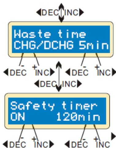
Во время процесса заряда/разряда батарея нагревается. Программа позволяет вставить временной промежуток (паузу) между каждым циклом заряда/разряда, тем самым позволяя батарее охладиться. Данный промежуток может изменять от 0 до 60 минут.
