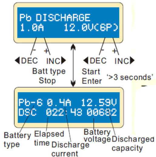
Установите разрядный ток в левой части дисплея и номинальное напряжение в правой части. Разрядный ток может быть 0.1-1.0A, напряжение должно выставлено соответственно разряжаемой батареи. Нажмите и удерживайте более 3-х секунд кнопку **START/ENTER** для запуска разрядки.
