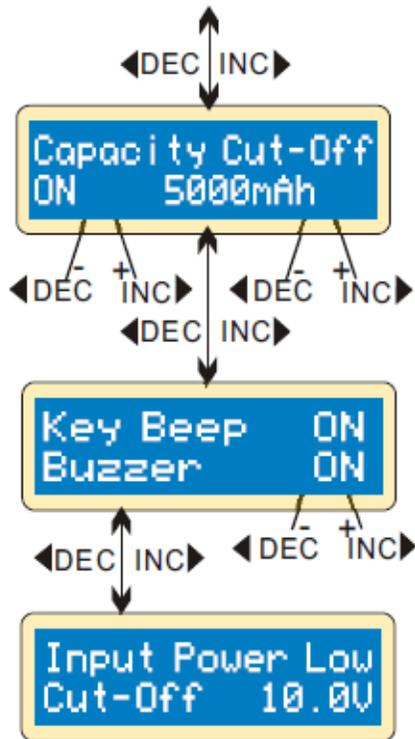
Программа обеспечивает функцию защиты батареи по максимальной емкости. Если Дельта пиковое напряжение не может быть определено и не вышло время сработки таймера, процесс зарядки остановится автоматически при достижении максимальной емкости заряда, установленной пользователем.
