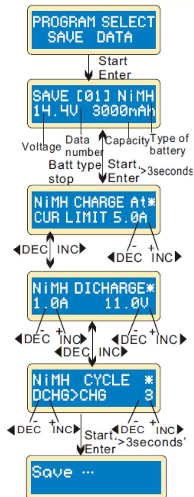
Установка параметров на экране не влияет на процесс зарядку и разрядки. Она только представляет спецификацию батареи.
