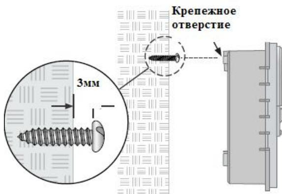
► Второй крепежный винт нужно винтить в стену через открытое отверстие внутри контроллера, там, где находятся клеммы. Убедитесь, что устройство надежно закреплено на стене.
