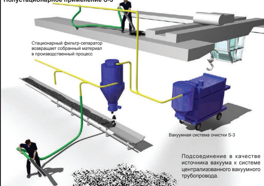
Подсоединение в качестве источника вакуума к системе централизованного вакуумного трубопровода.
