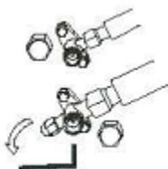
7. Проверьте все трубные и гаечные соединения на утечку. Если обнаружена утечка, примите меры по её устранению. Ни в коем случае нельзя допускать утечку.
