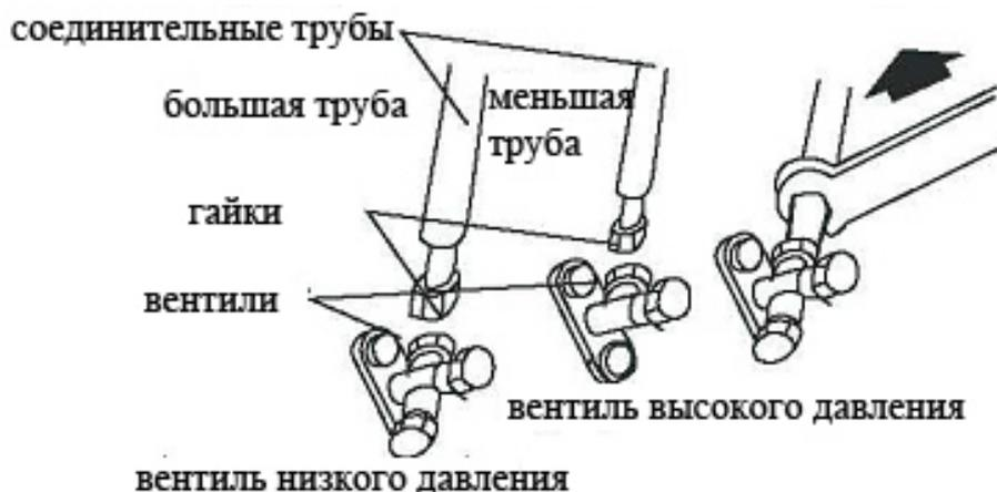
3. С помощью вакуумного насоса, свакууммируйте магистраль, удалив из неё весь воздух.
