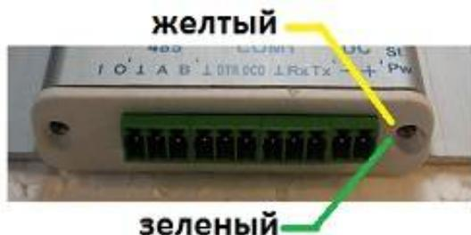
Желтый светодиод «St» - сигнализирует о процессе обмена данными.
