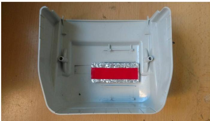
Затем, сняв защитную пленку со скотча с другой стороны пластины, приклеиваем к пластине сам модем, с заранее присоединенными антенной и интерфейсным кабелем (!), как показано на фото ниже:
