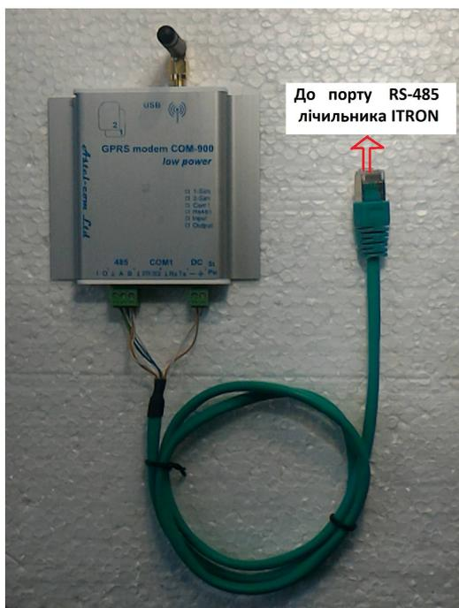
Обращаем Ваше внимание, что подключение модема производится только к порту RS485 счетчика.
