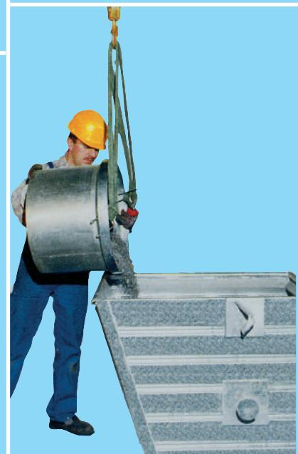
Выгрузка собранной металлической стружки
