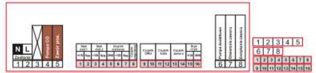
Малюнок 7. Схема клем, призначених для підключення внутрішніх, зовнішніх датчиків та інших компонентів котла.
