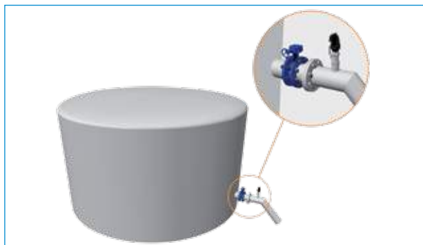
Выход из резервуара, после обратного клапана
