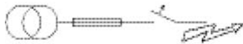
Характеристика В избирательности по току короткого замыкания в направлении плавкой вставки DIAZED*)
