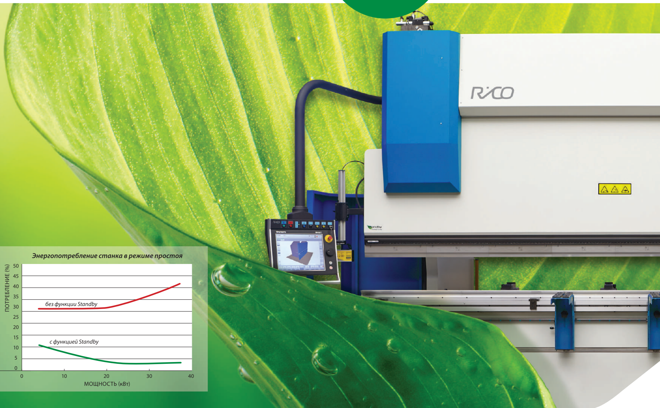
Зависимость экономии в режиме Standby от мощности машины
