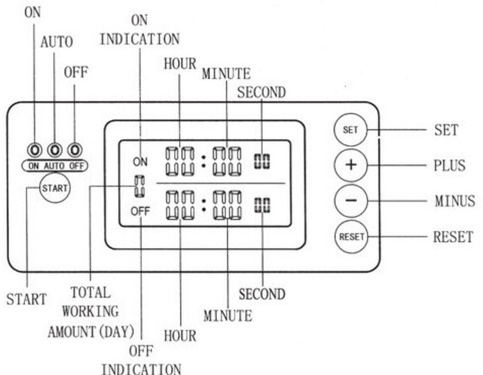
**Информация по жидко кристаллическому ЖК индикатору/контроллеру системы туманообразования Вдох-Нова.** ЖК контроллер находится на верхней панели системы туманообразования Вдох-Нова ВД и обеспечивает работу встроенного насоса высокого давления в непрерывном и импульсном режиме, согласно заданным пользователем значениям встроенного таймера. Также, контроллер управления имеет:
