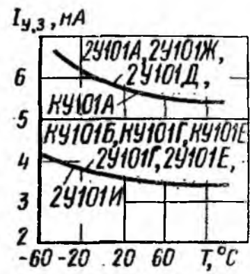
Зависимости отпирающего постоянного тока управления от температуры
