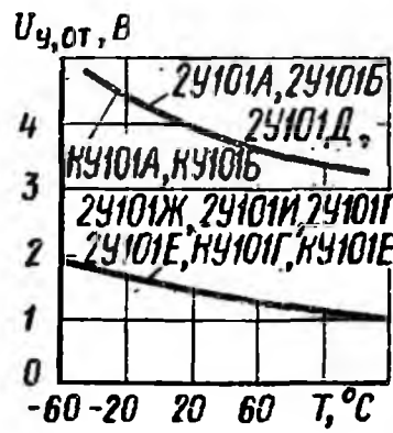
Зависимости отпирающего постоянного напряжения управления от температуры
