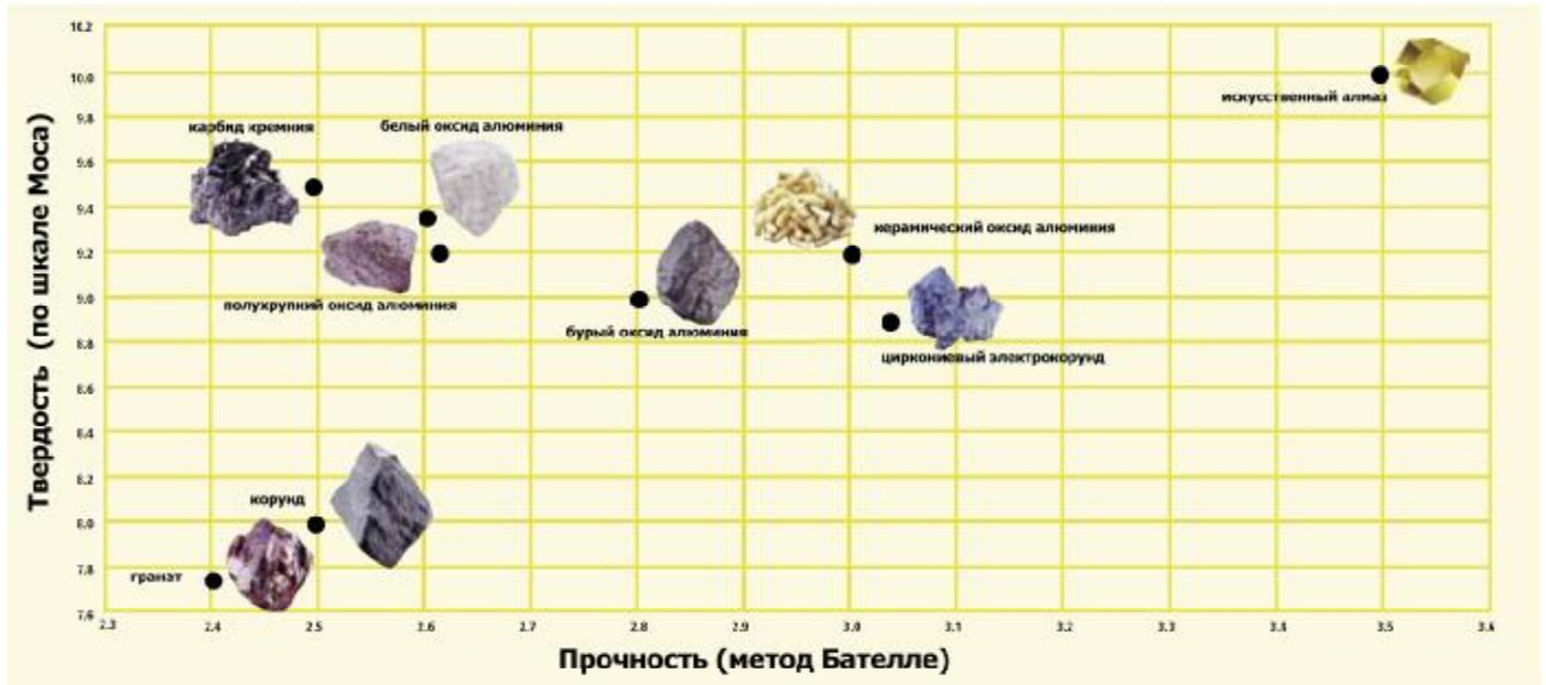
В настоящее время в качестве абразивного материала обычно используются синтетические материалы оксид алюминия и карбид кремния в различных формах. Также все чаще используются специальные минералы, такие как циркониевый корунд, керамический оксид алюминия и алмаз. Быстро сокращается применение таких естественных минералов, как гранат и корунд. Твердость и острота используемого минерального камня определяет характеристики и назначение изготавливаемого абразивного продукта.
