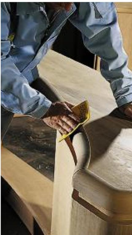
Оптимальное распределение давления, обеспечиваемое губкой, гарантирует прекрасное шлифование. Давление каждого пальца равномерно распределяется по поверхности, исключая образование отдельных глубоких царапин. Снижается уровень забиваемости, меньше вероятность сквозного повреждения лакового покрытия, финишная поверхность ровнее и равномернее.
