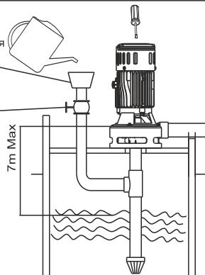
Перед запуском нужно повернуть лопасть вентилятора, проверьте, свободно ли вращение вала электродвигателя. Затем, откройте запорную арматуру (кран), расположенный на отводе для заполнения водой всасывающего трубопровода, заполните чистой водой всасывающий трубопровод. Закройте запорную арматуру (кран). Для выпуска воздуха из системы в период цикла всасывания, откройте любое водозаборное устройство напорного трубопровода (например, водопроводный кран) и запустите насос.
