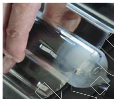
газопоглотитель разрушен, трубка неисправная
