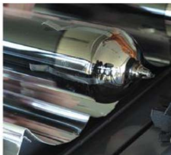
газопоглотитель в порядке, трубка исправная
