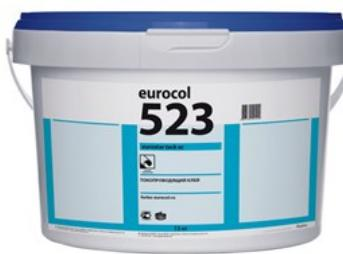
Токопроводящий клей. Водно-дисперсионный токопроводящий клей с высокой клеющей способностью для укладки токопроводящих ПВХ, виниловых и текстильных покрытий на поверхности, предварительно обработанные токопроводящей водно-дисперсионной грунтовкой 041 Europrimer EC, или на сетку из Медной ленты 801.
