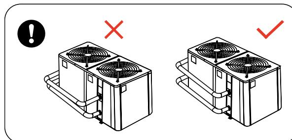
2.1.2. Для обеспечения эффективности нагрева, длина водопровода должна составлять ≤10м между бассейном и тепловым насосом.
