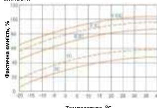
Рисунку 2 – Залежність ємності АКБ від Т (AV)
