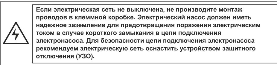
1. Электрические соединения и защита должны быть проведены согласно норм и правил установки электрооборудования. Спецификация рабочего напряжения отмечена на табличке с изделием. Обеспечьте соответствие электрических параметров электродвигателя с параметрами электрической сети.
