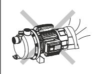
5. Насос должен находиться в вентилируемом помещении, конструкция которого должна предотвращать проникновение атмосферных осадков на корпус и внутрь электродвигателя.
