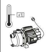
6. В случае падения температуры окружающей среды ниже 4 °C, или в случае длительного простоя насоса, пустая гидросистема может быть повреждена. Не используйте насос при длительном отсутствии воды.
