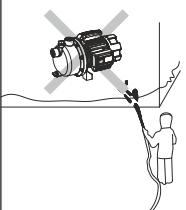
4. Избегайте разбрызгивания воды под давлением в электрический насос, а также не допускайте погружения (даже частичного) электронасоса в воду.
