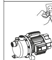
9. Следите, чтобы насос неожиданно не включился при монтаже или демонтаже, в этом случае и при длительном простое всегда держите сетевой тумблер выключенным, а входной и выходной клапаны закрытыми.
