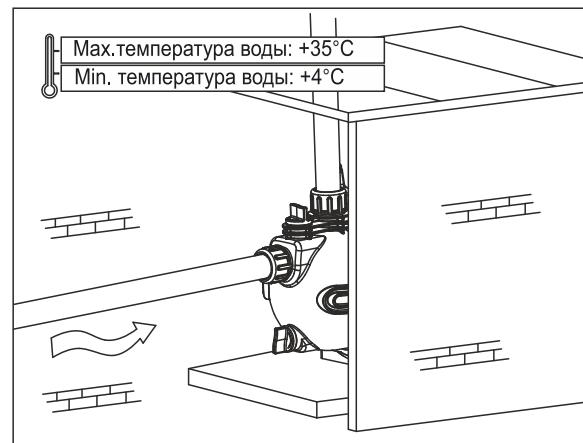
1. Для установки насоса входная труба должна быть настолько короткой насколько возможно с наименьшим количеством изгибов. Насос должен быть установлен в вентилируемом и сухом месте. Насос может быть установлен на улице с условием обеспечения надлежащего перекрытия для предотвращения негативного влияния погодных условий.
