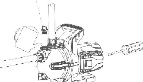
Перед запуском нужно повернуть лопасть вентилятора, проверьте, свободно ли вращение. Затем, открутите заливную пробку, заполните насосную часть чистой водой. Закрутите заливную пробку. Для выпуска воздуха из системы в период цикла всасывания, откройте любое водозаборное устройство напорного трубопровода (например, водопроводный кран) и запустите насос.
