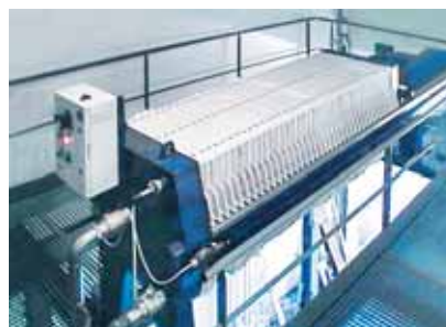
При помощи системы управления seeplex FPPU достигается оптимальная загрузка фильтр-пресса эксцентриковыми шнековыми насосами seeplex .
