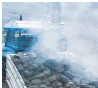
К шламу в насос добавляется известь, и этим шлам стабилизируется и обезвреживается. Сухой остаток повышается при этом примерно до 40%.
