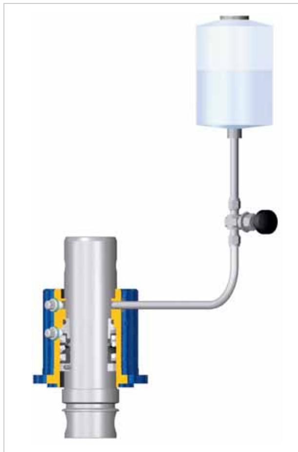
Детальное изображение: Уплотнение вала
