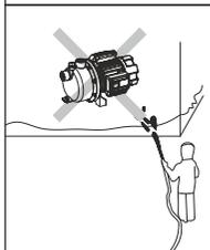
4. Избегайте разбрызгивания воды под давлением в электрический насос, а также не допускайте погружения (даже частичного) электронасоса в воду.
