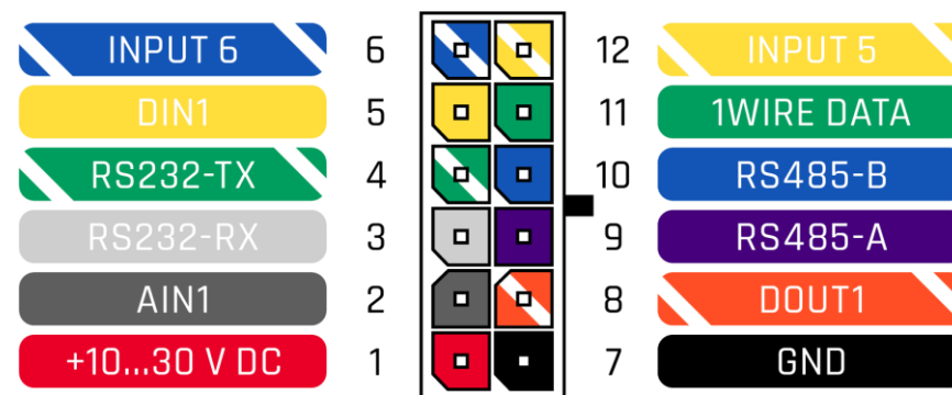
Рисунок 2 Распиновка разъема 2x6 FMB125
