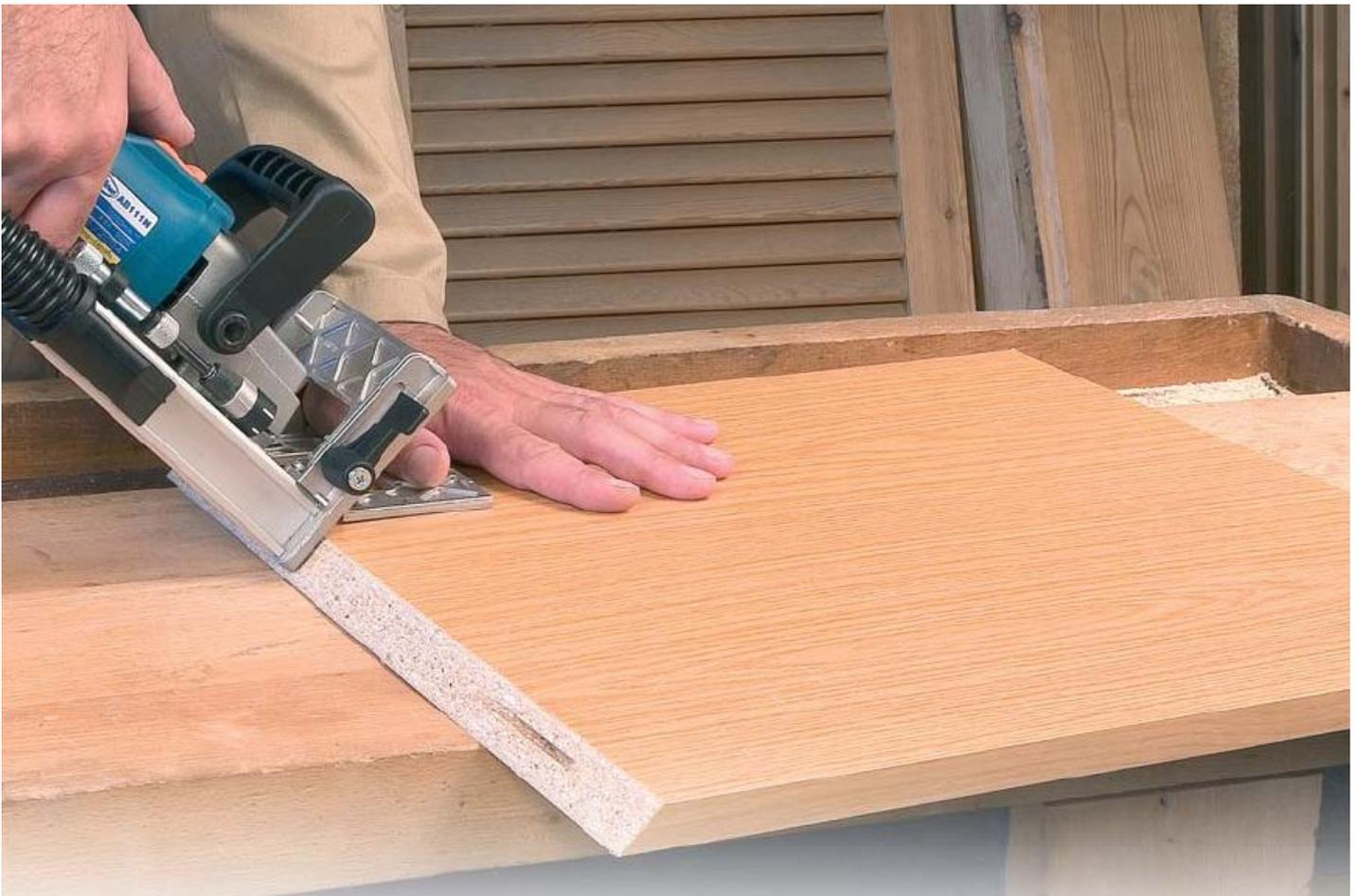
Фрезер АВ111N разработан для выборки пазов в любом месте заготовки. Конструкция переднего упора позволяет осуществлять регулировку по углу и высоте в соответствии со шкалой настройки, и выполнять паз в соответствии с линией разметки. Паз выполняется с припуском для последующей регулировки местоположения соединяемых деталей.
