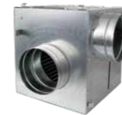
Ventilator / Ventilatorbox Der Ventilator ist ein Langsamläufer. Er ist thermisch und schalldicht montiert, in einer Box aus verzinktem Blech mit Luftstutzen und Zuführkabel. Er bewegt die Warmluft innerhalb der Hypokaustenanlage und ist mit einem Thermostatfühler versehen.
