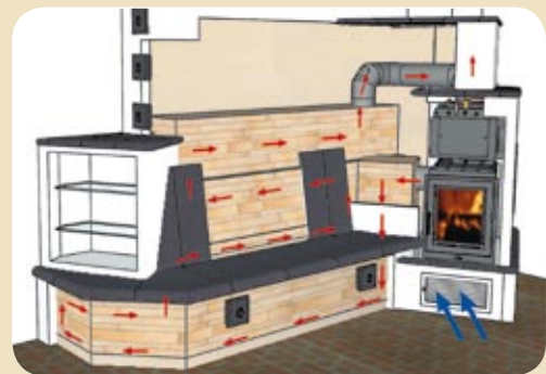
... mit Heizwasser-Aufsatzregister (für die Anbindung an das Heizungssystem) und keramischem Zug.
