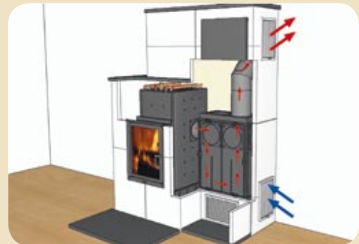
... als Kesselgerät (mit Anbindung an das Heizungssystem) und Nachheizkasten.
