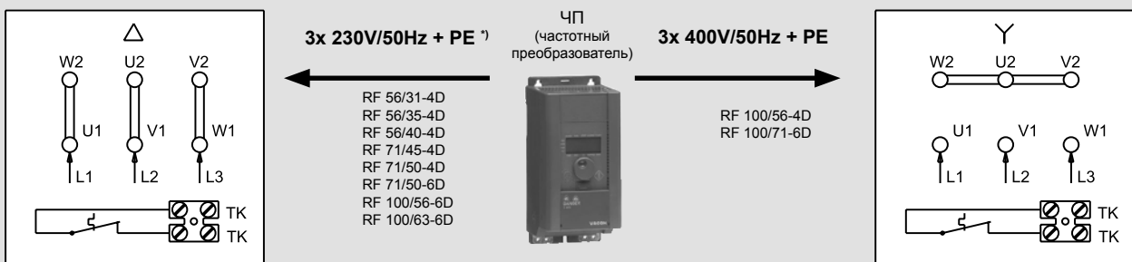
Рисунок 6 – включение в звезду/треугольник (Y/Δ) 3-х фазного электромотора
