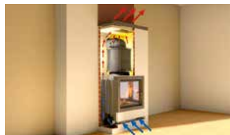
... комплектация топки шамотным теплонакопителем
