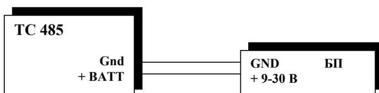
Использование модуля TC485 в конфигурации с внешним источником питания.
