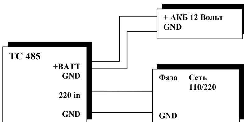
Подключение к 1-но фазной сети переменного тока и резервному аккумулятору.
