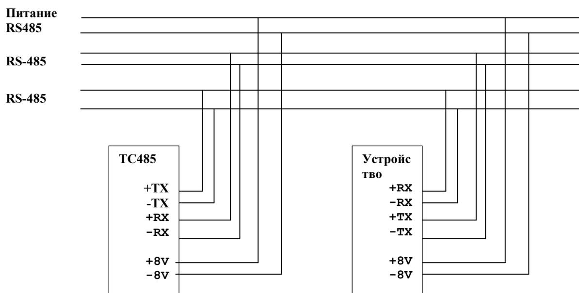
Схема подключения устройства в RS485/422 (Полный дуплекс, питание драйверов RS485 от модуля, используются 3 витые пары)
