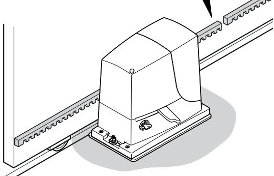
п - затем отрезать оставшуюся часть зубчатой рейки
