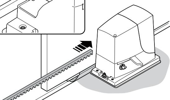
l - зафиксировать часть зубчатой рейки
