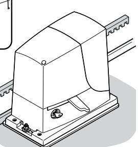
т - передвинуть вручную створку, используя шестерню, как контрольную точку для закрепления других элементов зубчатой рейки
