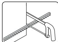
06. Вручную перевести створку в положения Открытия и Закрытия, чтобы проверить, что зубчатая рейка выровнена относительно шестерни.
