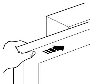
i - установить на шестерню электропривода первую часть зубчатой рейки: проверить, чтобы она совпадала с началом створки и что между шестерней и зубчатой рейкой обеспечивается расстояние 1÷2 мм (во избежание воздействия веса створки на электропривод)
