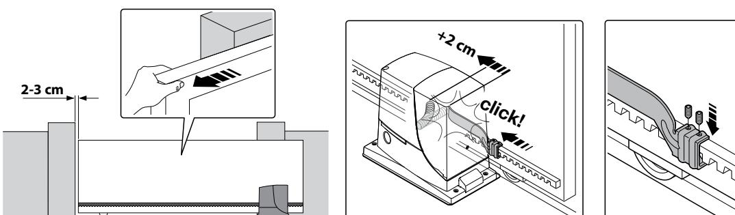
09. Вручную закрепить электропривод
