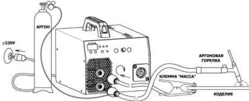
**Внимание!** В качестве защитного газа применяется чаще всего чистый аргон "Ar", иногда гелий "He", а также их смесь в различных пропорциях. НЕ ДОПУСКАЙТЕ использование горючих газов! Использование других газов только по согласованию с производителем оборудования.
