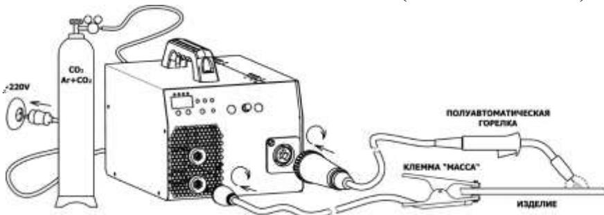
**Внимание!** В качестве защитного газа применяется при сварке чёрных металлов в простейшем случае углекислый газ "CO<sub>2</sub>", а при сварке алюминия только инертные газы типа аргон "Ar", иногда дорогой гелий "He", для нержавеющих и высоколегированных сталей часто применяются смеси в различных пропорциях "80%Ar+20%CO<sub>2</sub>". Использование других газов только по согласованию с производителем оборудования.
