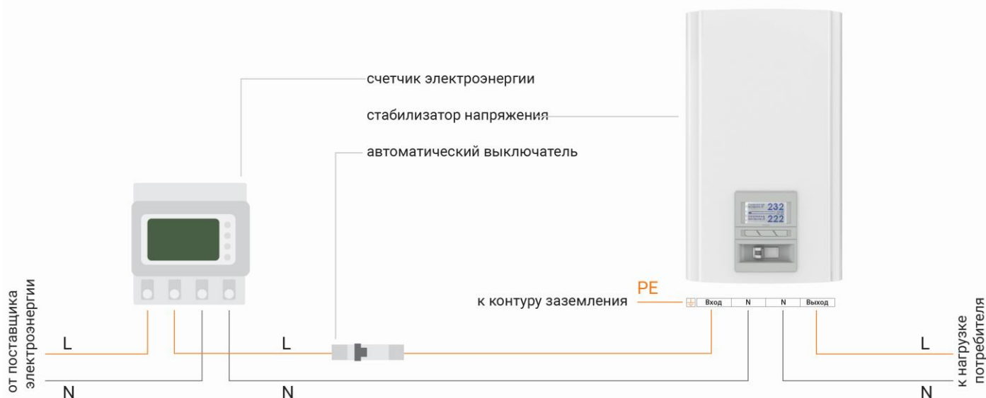
Рисунок 10. Схема подключения Герц и Герц-Дуо к однофазной сети
