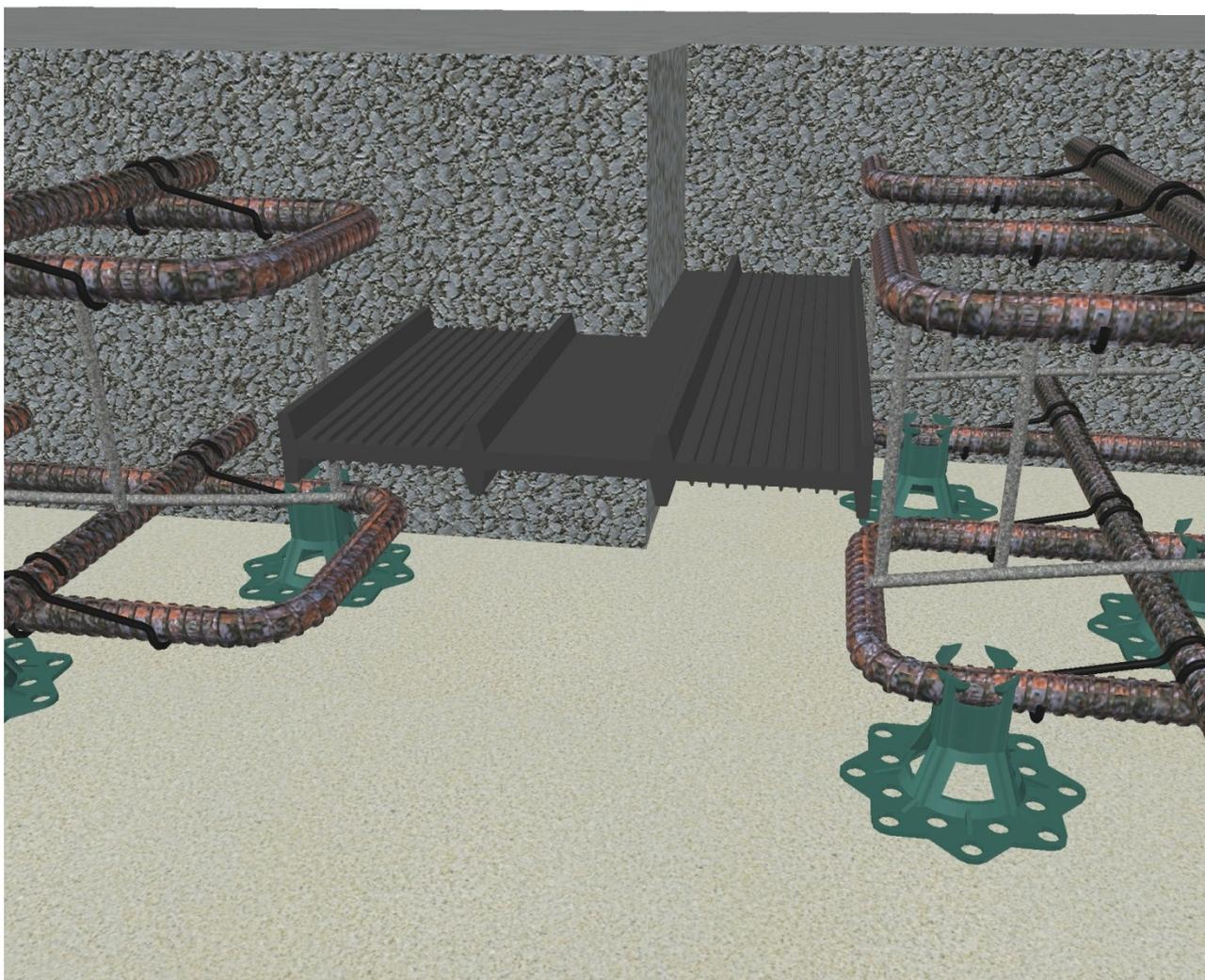
**Конфигурация гидрошпонки ВТ<sup>®</sup> позволяет герметизировать технологические швы ж/б конструкций , пересекающиеся в 2-х и в 3-х плоскостях.**
